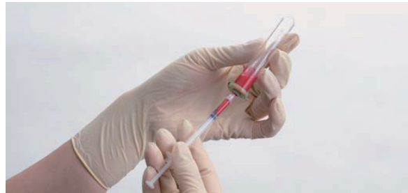
② ①の検体のうち150μLを、カーディアックシリンジ、または150μLを定量可能なピペットに採取します。
